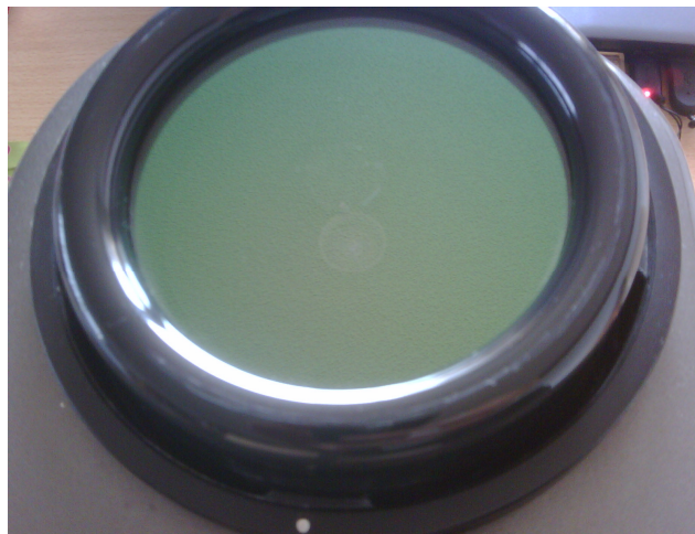
Messelektrode mit leichtem Kratzer vom Testobjekt, der jedoch nicht die Qualität der Aufnahmen beeinträchtigt
